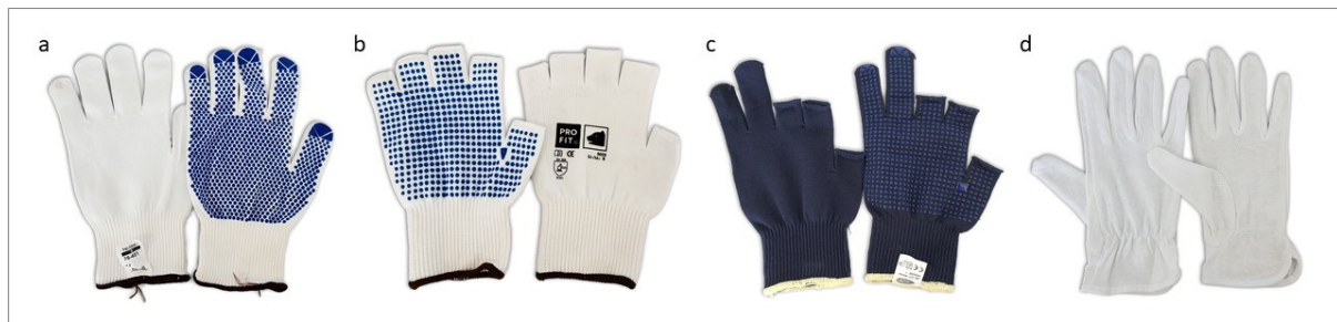
Abbildung 30: Exemplarische Auswahl verschiedener teilbeschichteter Textilhandschuhe: a) Tri-Grip®-Handschuhe, einseitige PVC-Noppen auf Stretch-Nylon-Gewebe (nicht mehr erhältlich, Fa. Ansell Ltd., BEL); b) Fingerlose Feinstrickhandschuhe, einseitige PVC-Noppen auf Polyamid (Fa. Fitzner GmbH & Co. KG, DEU); c) Strickhandschuhe Mishan, einseitige PVC-Noppen auf Polyamid-/Baumwoll-Feinstrick (nicht mehr erhältlich, Fa. Feldtmann, DEU); d) Spezial-Baumwollhandschuhe, einseitige Mikro-Noppen (Fa. Finnimport GmbH, DEU) [Eigene Aufnahmen]
