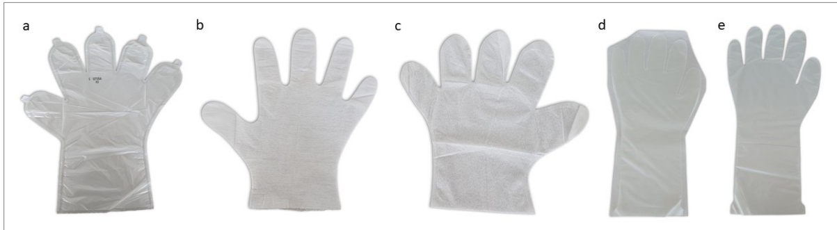
Abbildung 35: a-e) Prototypen des Sympatex®-Handschuh mit/ohne Transferpapier bzw. Papierträger (Fa. Sympatex Technologies GmbH, DEU) [Eigene Aufnahmen]
