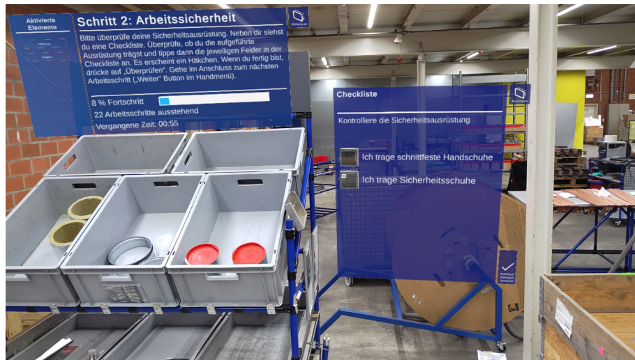
Abb. 8. Ausschnitt einer AR-basierten Montageanleitung (in Anlehnung an Dreesbach et al. 2023)
