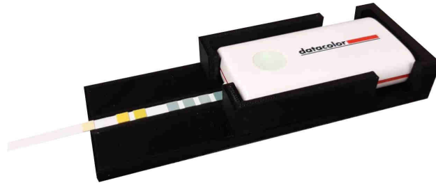
Abbildung 41: Versuchsaufbau zur Untersuchung von Störeinflüssen auf die Messung mit den verwendeten Nitrat-Teststäbchen (Abbildung verändert nach Rolf, 2021, S. 22).
