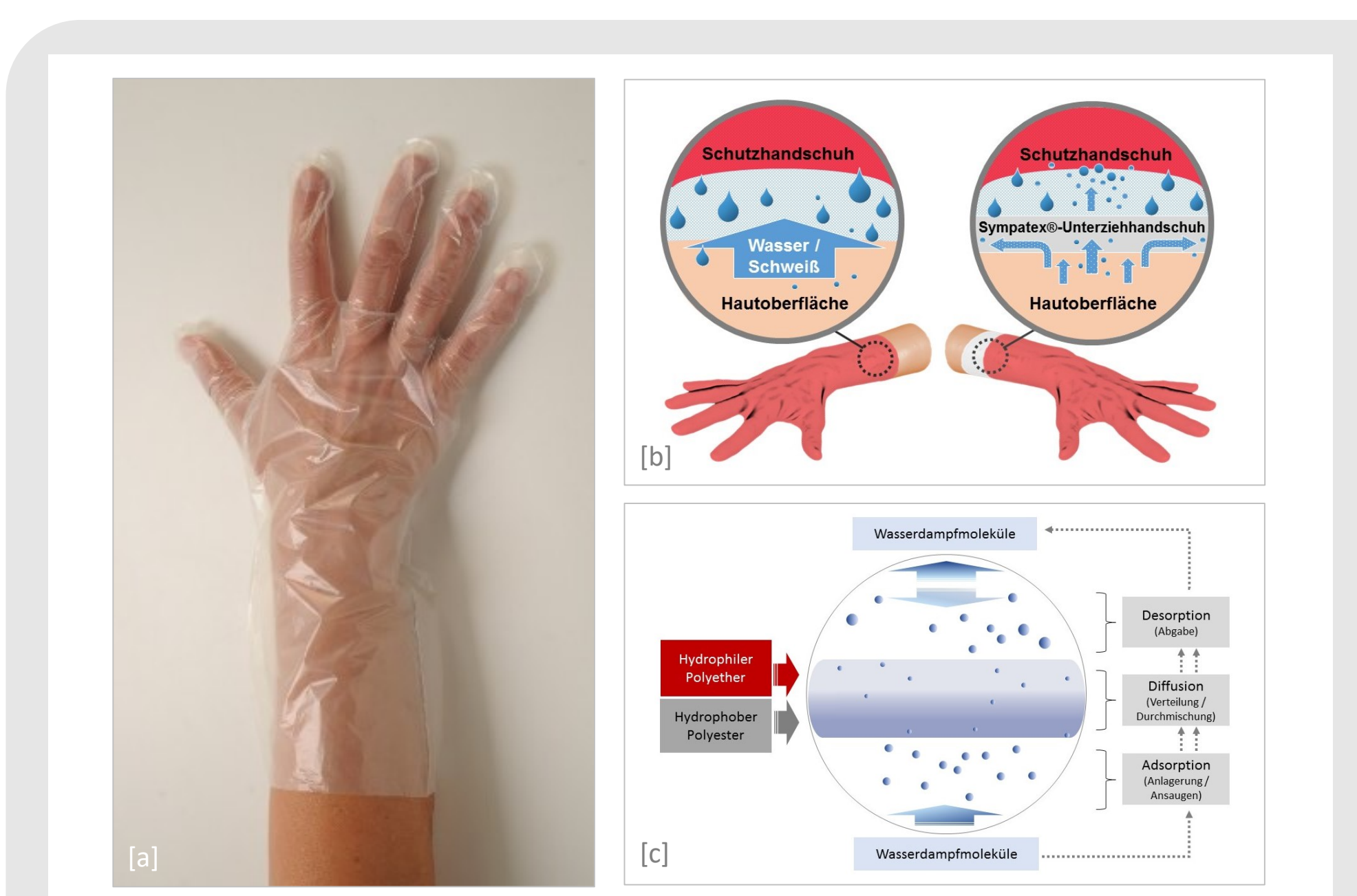
Abbildung 1: Sympatex®-Unterziehandschuh – Aussehen und Funktionsweise a: Sympatex®-Handschuh angezogen b: Linke Seite: Feuchtigkeitsstau unter Schutzhandschuh; Rechte Seite: Feuchtigkeit wird durch die Sympatex®-Membran in den Handschuhzwischenraum und über die Handschuhstulpe nach außen abtransportiert c: Transport von Wassermolekülen entlang der hydrophilen und hydrophoben Anteile in der Membran
