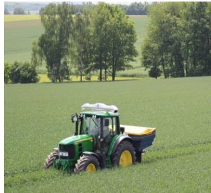
Abbildung 3: Traktor mit Stickstoff-Sensor auf dem Dach für eine teilflächenspezifische Düngung (Agricon GmbH)
