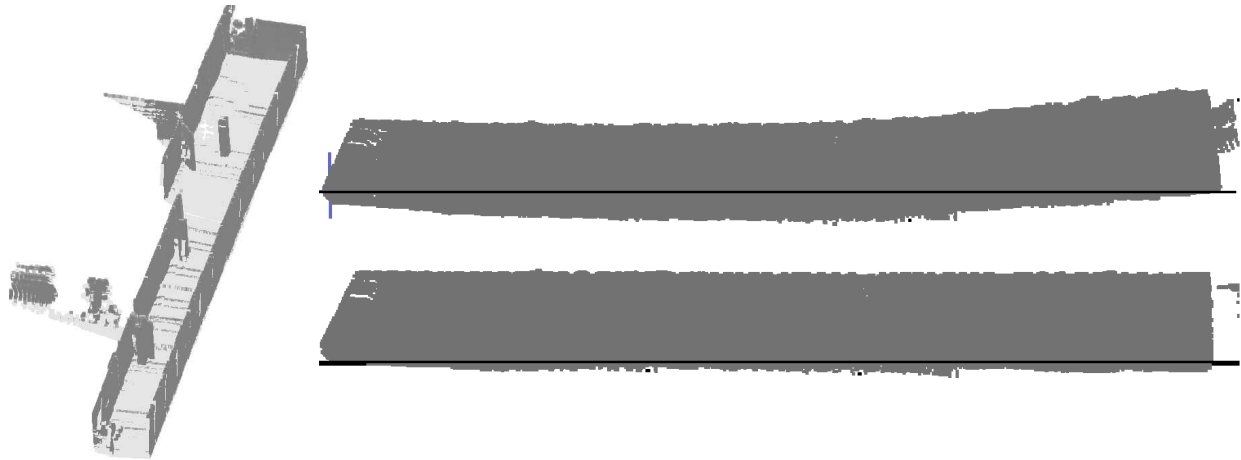
Abbildung 5.2: Links: Aufsicht auf die registrierte Punktwolke der Umgebung. Rechts, oben: 6D-Scanmatching ohne semantische Korrektur erzeugt eine bananenförmige Umgebung. Rechts, unten: 3D-Scanmatching mit semantischer Korrektur erzeugt qualitativ korrekte Umgebungsmodelle [81].
