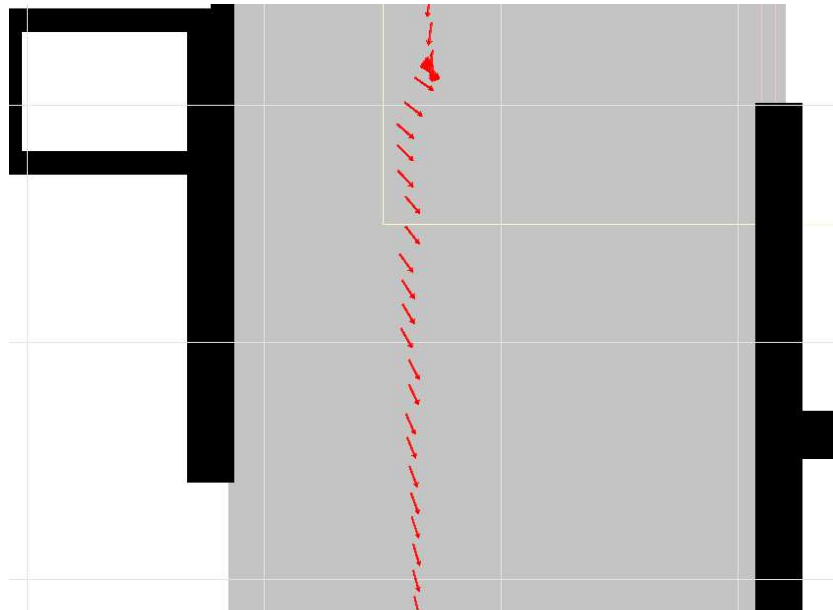
Abbildung 7.5: Anpassung der Orientierung des LiSA-Roboters parallel zum Korridor. Hat der Roboter eine zur Hauptachse des Korridors verschiedene Orientierung (hier manuell erzeugt), wird die Bewegungsrichtung des Roboters mit einer Rotationsbewegung überlagert, die die Winkeldifferenz zwischen Korridor und Roboterorientierung ausgleicht.
