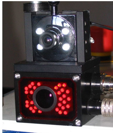
Abbildung 6.20: Photonic Mixer Device (PMD)-Kamera in Kombination mit einer RGB-Kamera: Die PMD-Kamera (unten) leuchtet die Szene aktiv mit einem Feld von Dioden aus und liefert über Laufzeitmessungen eine 3D-Punktwolke der betrachteten Szene. Den einzelnen Punkten können durch die RGB-Kamera (oben) Farbwerte zugewiesen werden.
